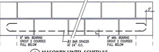
MASONRY LINTEL SCHEDULE SCALE: 1'-1'-0"
